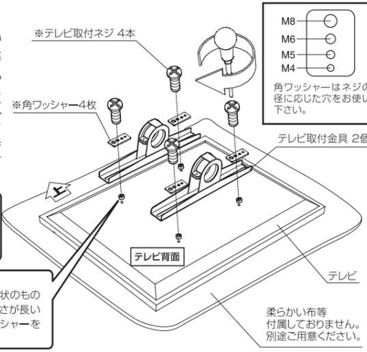
●テレビ取付ネジでテレビ取付金具を固定する際、5回転以上ネジが回らない場合は、使用しないでください。
