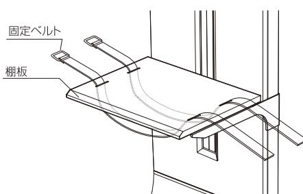
②機器を載せ固定ベルトで固定します。
