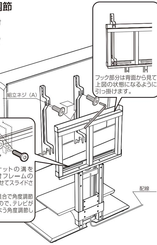
スライドナットの溝をテレビ取付フレームの長穴に合わせてスライドさせます。ネジの締め具合で角度調節が出来ますので、テレビが垂直になるよう角度調節して下さい。
