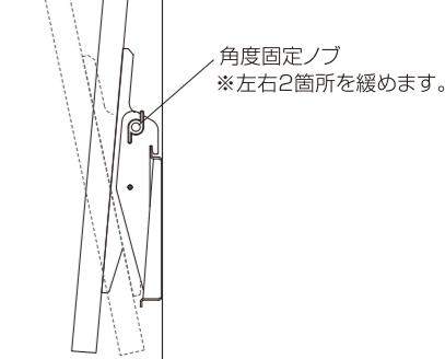
角度調節した後は、必ず角度固定ノブをしっかりと締め付けてください。
