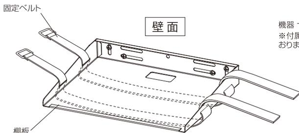
②機器を載せ固定ベルトで固定します。
