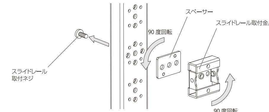
②スライドレール取付ネジでスライドレール取付金具とスペーサーを固定します。
