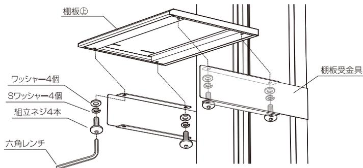
②棚板受金具に棚板⑤を組立ネジで仮締めします。
