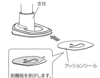
④板穴に支柱を合わせハンドルで下から締め付けます。
