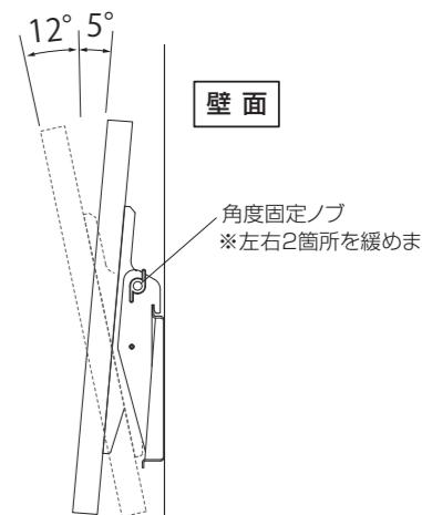
角度調節した後は、必ず角度固定ノブをしっかりと締め付けてください。
