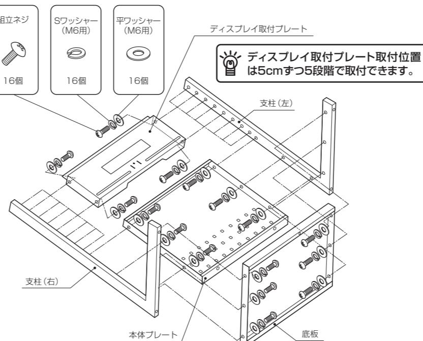
底板、プレート類は、上図を参考に上下・表裏に注意して取り付けてください。
