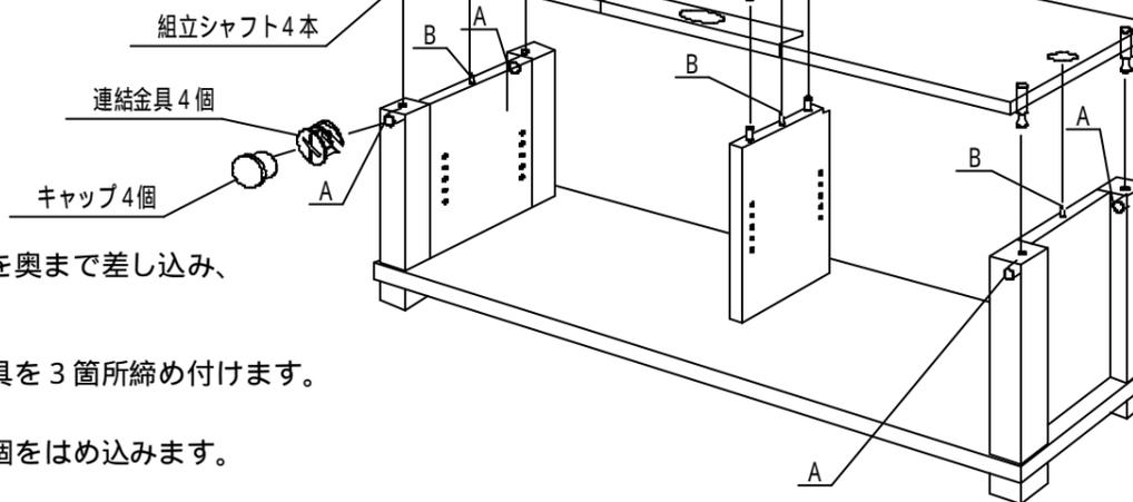
右図Aに連結金具4個を奥まで差し込み、締め付けます。
