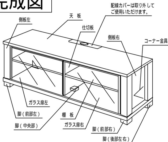
1 底板に側板・仕切板と各脚部を取付けます。
