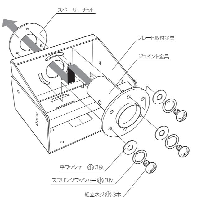
右図のようにジョイント金具をプレート取付金具、スペーサーナットの穴に通し、平ワッシャー (L)、スプリングワッシャー (L)、組立ネジ (L) で取り付けます。この後、テレビの左右の向きを調整する必要がある場合はネジを完全に締めず、少しゆるめの状態にしてください。
