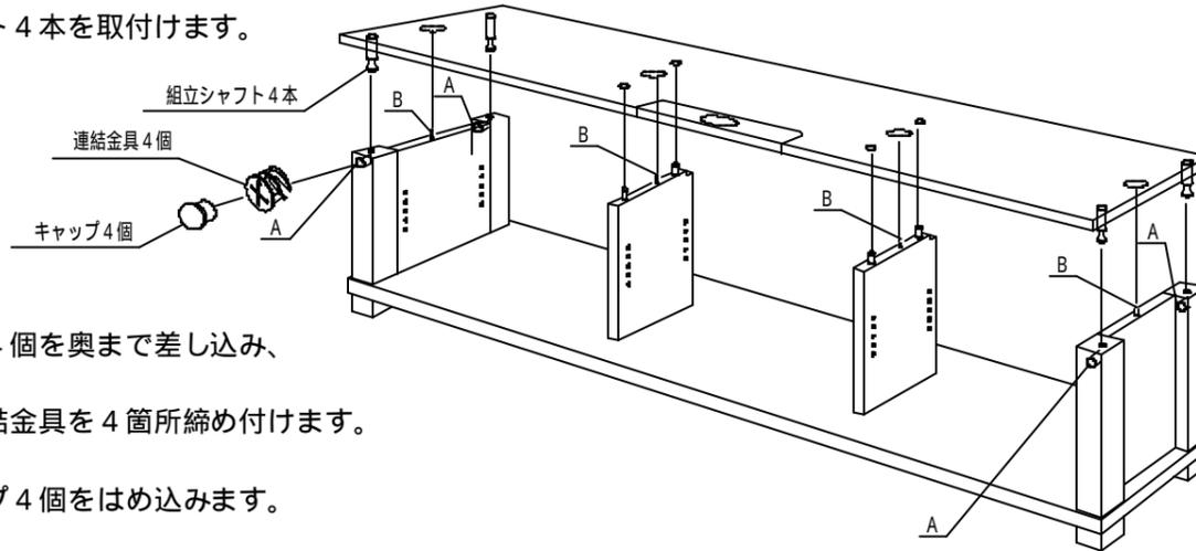
右図Aに連結金具4個を奥まで差し込み、締め付けます。
