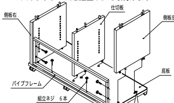
1. 底板に埋め込んであるジョイント部品のプラスネジを左に回し、ツメを開の状態にします
