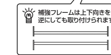
補強フレームは上下向きを逆にしても取り付けられます。
