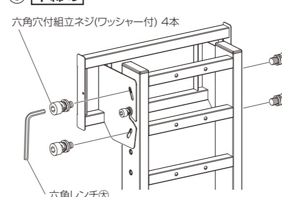
六角穴付組立ネジ(ワッシャー付)は電動ドライバー等を使用せず必ず手締めで取り付けをし、最後に六角レンチ(ワッシャー付)で本締めしてください。
