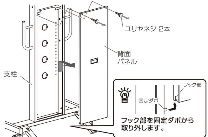
② 支柱の任意の高さにCPUホルダーを十字穴付組立ネジ(ワッシャー付)で取り付け、取り外した背面パネルを取り付けます。
