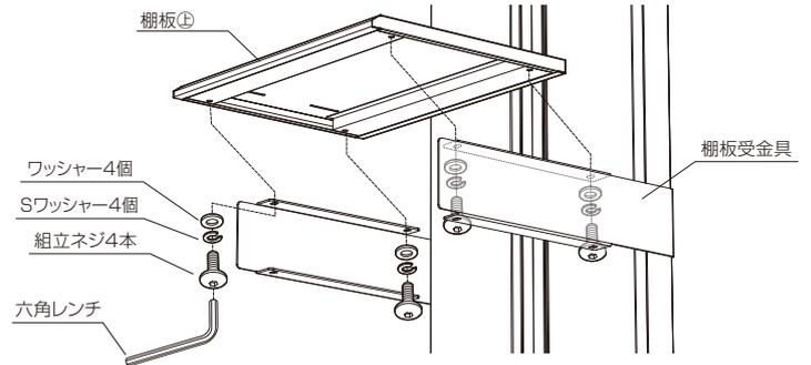
②棚板受金具に棚板⑤を組立ネジで仮締めします。
