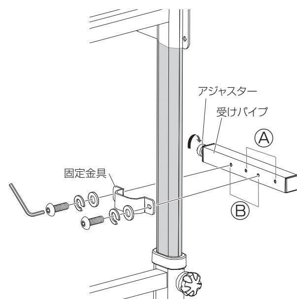
**💡 受けパイプの固定位置は取り付けられるディスプレイに応じて、Ⓐ/Ⓑのいずれかで固定してください。**
