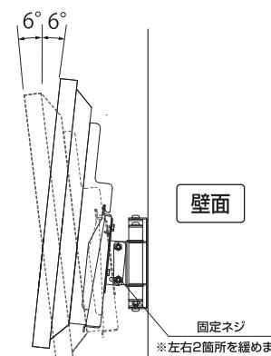
角度調節した後は、必ず4本の固定ネジをしっかりと③L型六角レンチ(大)で固定して下さい。
