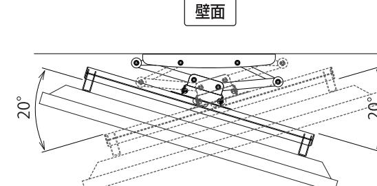
左右角度調節の動きの固さは、工場出荷時に調節済ですが、固さの強弱の調節を行う場合は、安全の為、必ず取付工事業者へご依頼下さい。
