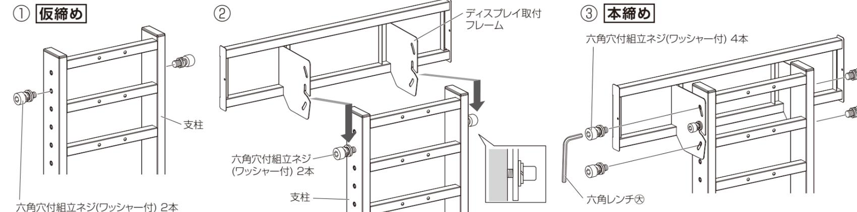
六角穴付組立ネジ(ワッシャー付)は電動ドライバー等を使用せず必ず手締めで取り付けをし、最後に六角レンチ⑧で本締めしてください。
