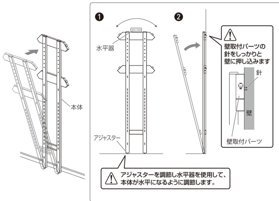
②固定ネジを外し、壁取付パーツが壁から外れないように静かに本体を外します。
