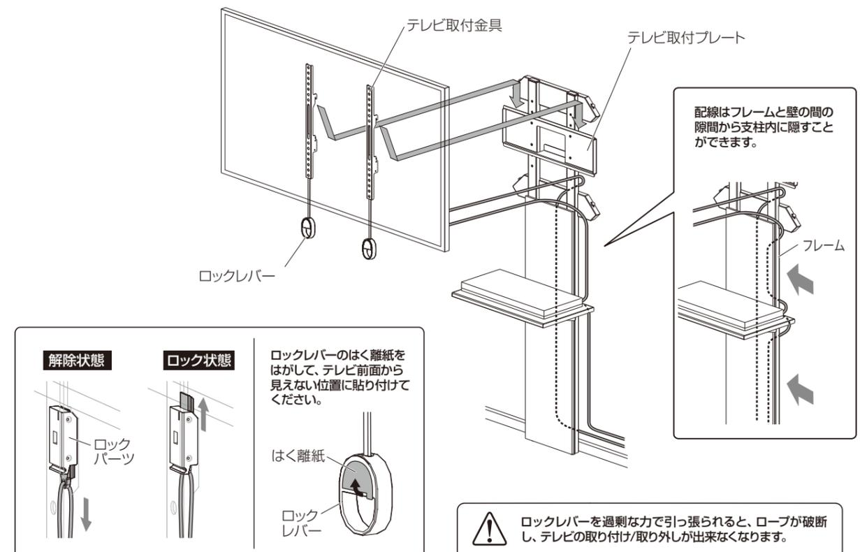
⚠️ ロックレバーを過剰な力で引っ張られると、ロープが破断し、テレビの取り付け/取り外しが出来なくなります。
