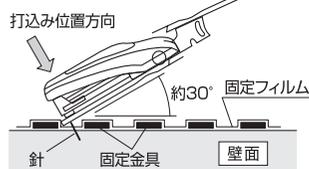
ホッチキスを図のように壁面と約30度の角度を保ちながら、打込みフィルム上に均等に当て、動かさないように片手でしっかり持ちます。もう一方の手で図に示す打ち込み位置、方向でゆっくりと針を打ち込みますが、最後まで、横置れしないよう、確実に針を打ち込んでください。
