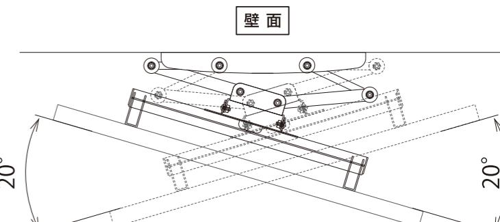
角度調節した後は、必ず4本の固定ネジをしっかりとL型六角レンチ(大)で固定してください。
