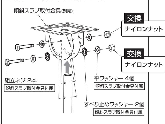
⚠️ 天吊金具の組み立て、テレビの取り付けは、CH-43B/43W・CH-63B/63W・CH-83B/83Wに付属の取扱説明書をご覧ください。
