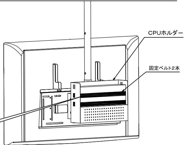
💡 機器落下防止のために付属の固定ベルトをスリットに通し固定してください。
