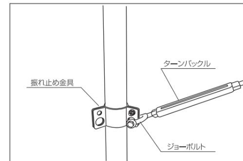
②ターンバックルのジョーボルトを振れ止め金具に取り付けます。
