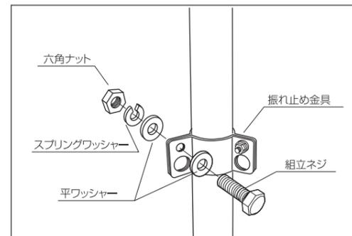
①振れ止め金具をハンガーパイプに取り付けます。
