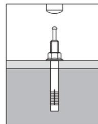
③ねじ山部分が約15mmナットから出るようにアンカーを挿入し、芯棒をハンマーで打ち込みます。
