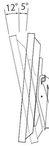
⚠ 角度調節した後は、必ず角度固定ノブをしっかりと締め付けて下さい。
