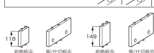
①側/仕切板Ⓐに連結金具をはめ込み、連結ネジのついた天板に差し込みます。
