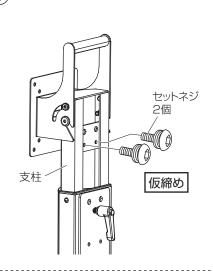
仮締めしたセットネジにSTBホルダーの 切り欠きを引っかけます。
