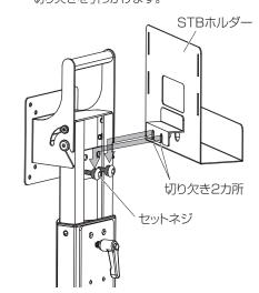
③ 仮締めしたセットネジをSTBホルダーの丸穴 からしっかりと締め込みます。
