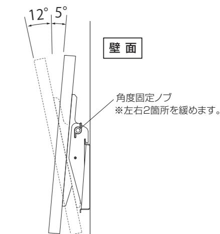
角度調節した後は、必ず角度固定ノブをしっかりと締め付けてください。
