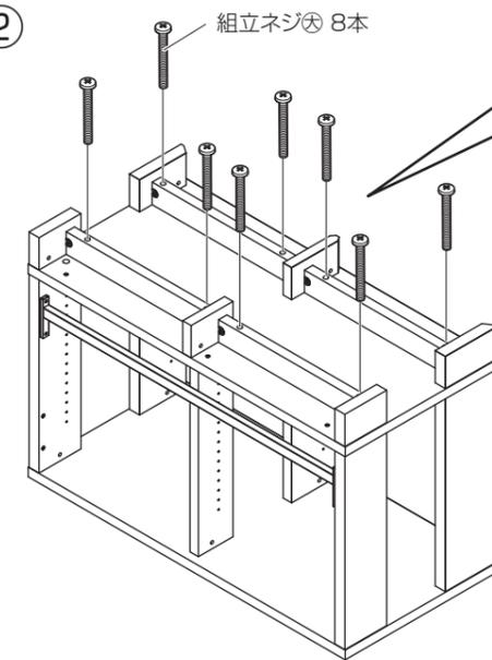
⚠️ 組立ネジ④で連結板を固定してから
