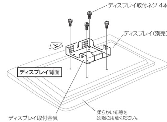
💡 ディスプレイの上下とディスプレイ取付金具の上下に注意して取り付けてください。
