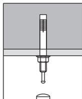
③ねじ山部分が15mm ナットから出るようにアンカーを挿入し、芯棒をハンマーで打ち込みます。
