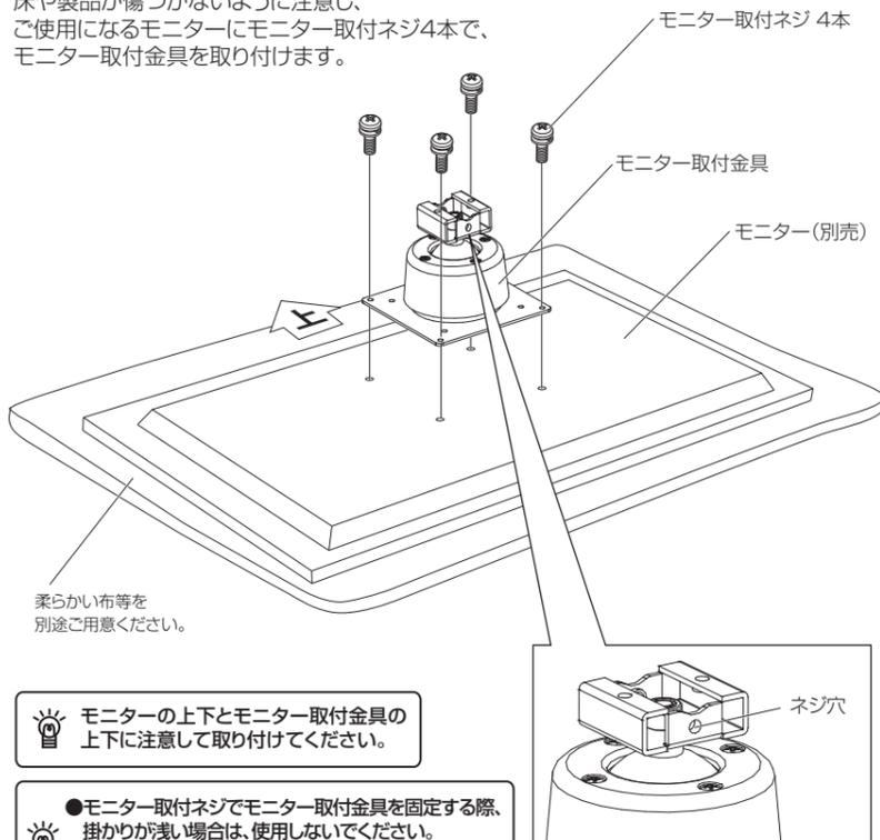
💡 **モニターの上下とモニター取付金具の上下に注意して取り付けてください。**
