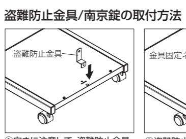
向きに注意して、盗難防止金具を底板の角穴に差し込みます。
