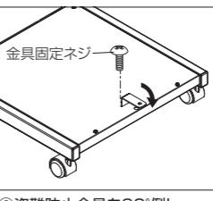
盗難防止金具を90°倒し、金具固定ねじで固定します。
