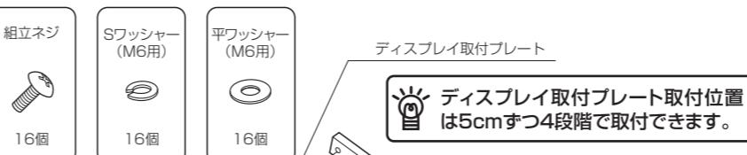
ディスプレイ取付プレート取付位置は5cmずつ4段階で取付できます。
