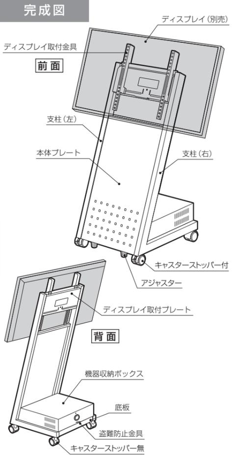
**1 支柱と底板、本体プレート、ディスプレイ取付プレートの取付**
