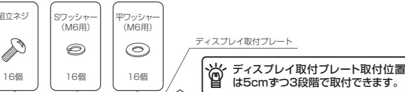
ディスプレイ取付プレート取付位置は5cmずつ3段階で取付できます。
