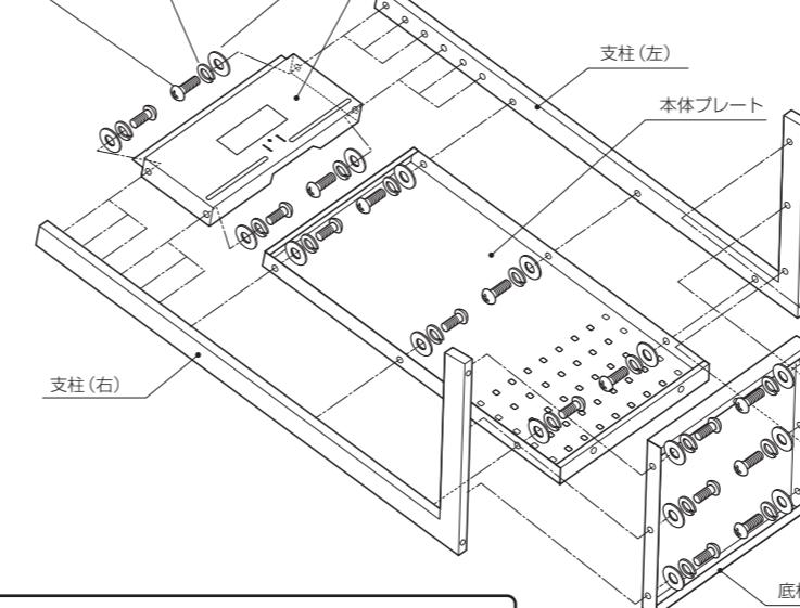
底板、プレート類は、上図を参考に上下・表裏に注意して取り付けてください。
