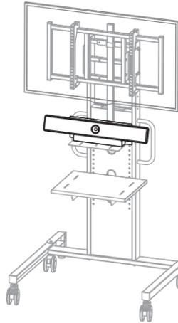
※本製品は、Cisco社製 Webex Room Kit / Webex Room Kit mini / Quad Camera専用の取付金具です。
