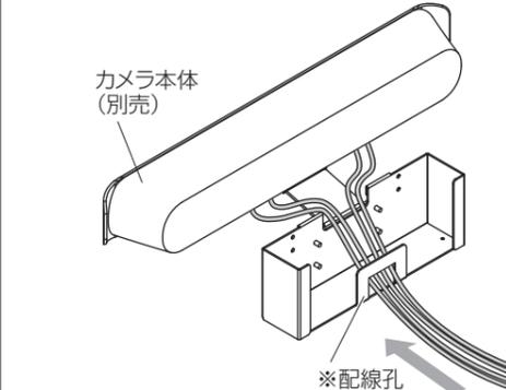
💡 配線がしにくい場合はカメラ本体下部の可動部分でカメラ本体を前方に倒し配線してください。
