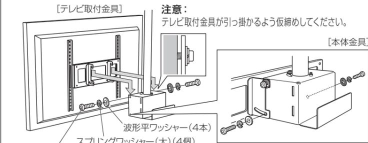
**⚠ 角度調整後、組立ネジを上下共に締め付けます。波形平ワッシャーは、ギザギザ面を本体金具(面)側にしてください。**
