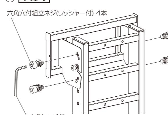
六角穴付組立ネジ(ワッシャー付)は電動ドライバー等を使用せず必ず手締めで取り付けをし、最後に六角レンチで本締めしてください。
