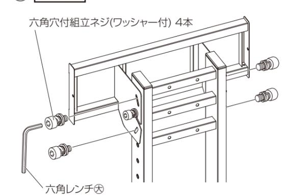
六角穴付組立ネジ(ワッシャー付)は電動ドライバー等を使用せず必ず手締めで取り付けをし、最後に六角レンチⒺで本締めしてください。
