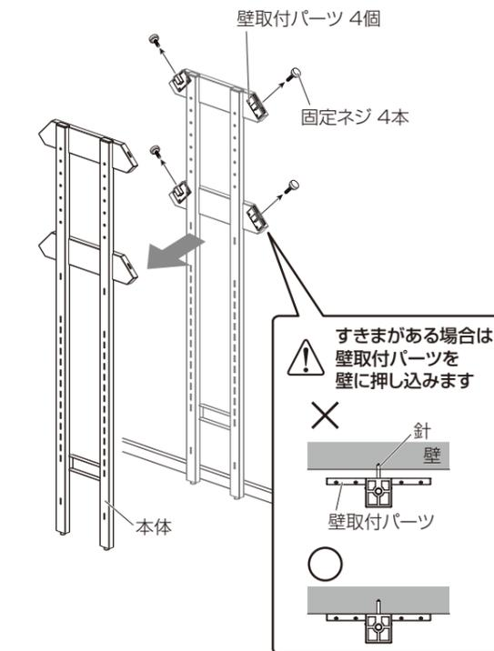
⚠️ すきまがある場合は壁取付パーツを壁に押し込みます
