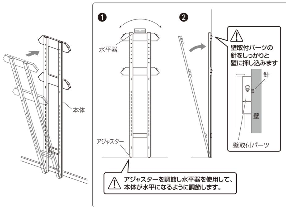
⚠️ アジャスターを調節し水平器を使用して、本体が水平になるように調節します。
