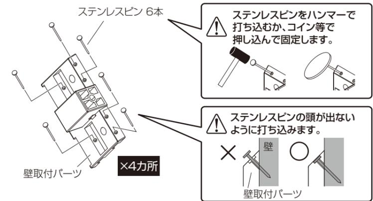
⚠️ ステンレスピンをハンマーで打ち込むか、コイン等で押し込んで固定します。
