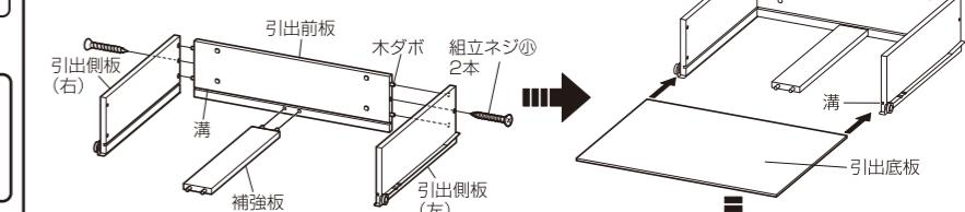
④引出後板を組立ネジ④で締め付けます。
