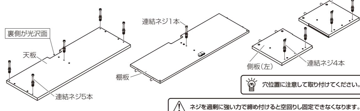
⚠ ネジを過剰に強い力で締め付けると空回りし固定できなくなります。
