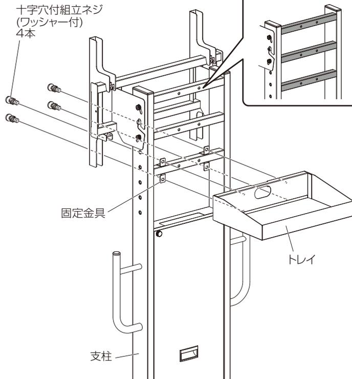
② 支柱の任意の高さに十字穴付組立ネジ(ワッシャー付)でトレイを取り付け、取り外した背面パネルを取り付けます。
