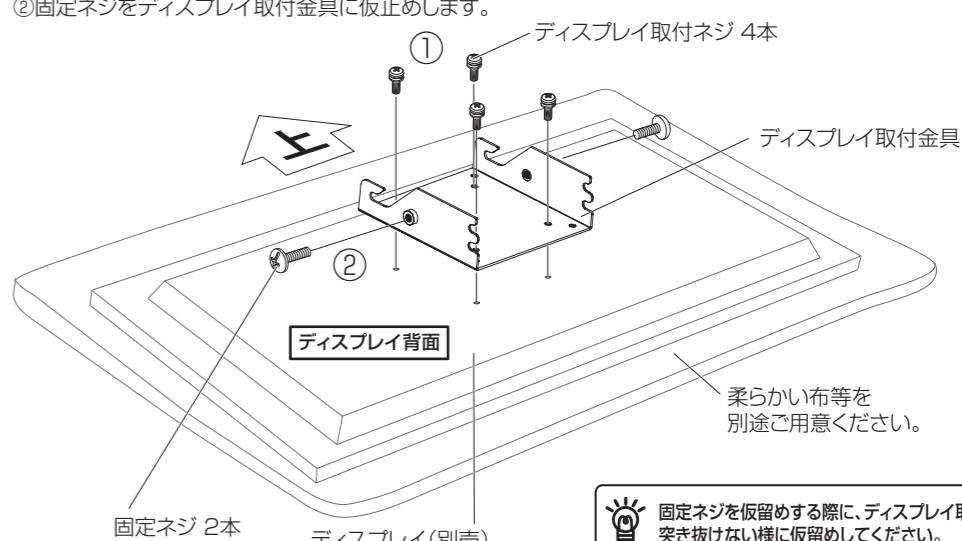
**⚠** 固定ネジを仮留めする際に、ディスプレイ取付金具を突き抜けないように仮留めしてください。
