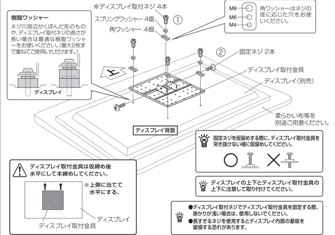
⚠️ **ディスプレイ取付金具は仮締め後水平にして本締めしてください。**
