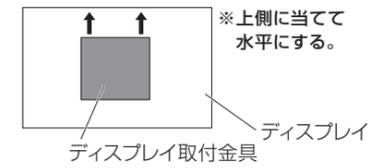
💡 **固定ネジを仮留めする際に、ディスプレイ取付金具を突き抜けない様に仮留めしてください。**
