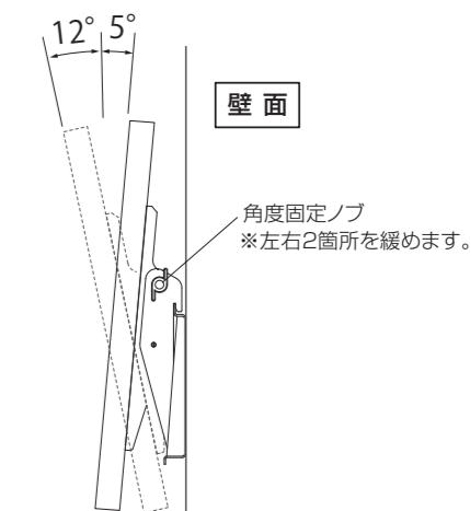
⚠ 角度調節した後は、必ず角度固定ノブをしっかりと締め付けてください。
